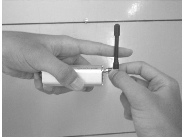
1. **Tahan antena dan eratkan** menggunakan jari tangan searah jarum jam. Jangan dieratkan menggunakan tang/kunci pas. **Garansi tidak berlaku jika antena patah atau kabel antena putus.**
